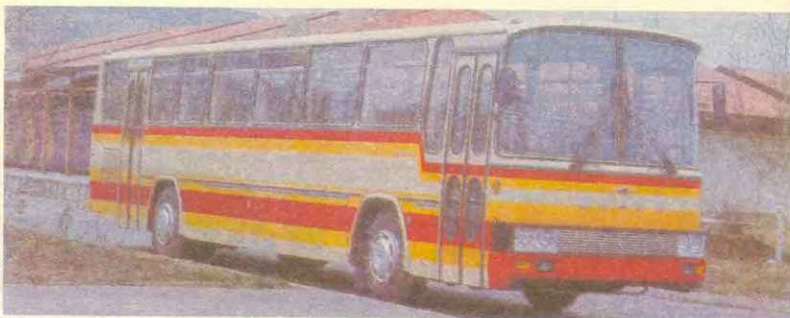
«С-415» для пригородных и междугородных маршрутов. Двигатель «Фамос» мощностью 147,1 кВт/200 л. с. Покупатель может выбрать модификацию как с пневматической, так и с
