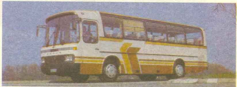
«Санос С-311». Укороченная, более маневренная и экономичная модификация модели «С-315» рассчитана на 41+1+1 место. Длина —
