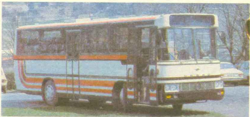
Еще один «маневренный» вариант — модель «411» с лицензионным двигателем «Мерседес-Бенц» мощностью 123,5 кВт/168 л. с.
